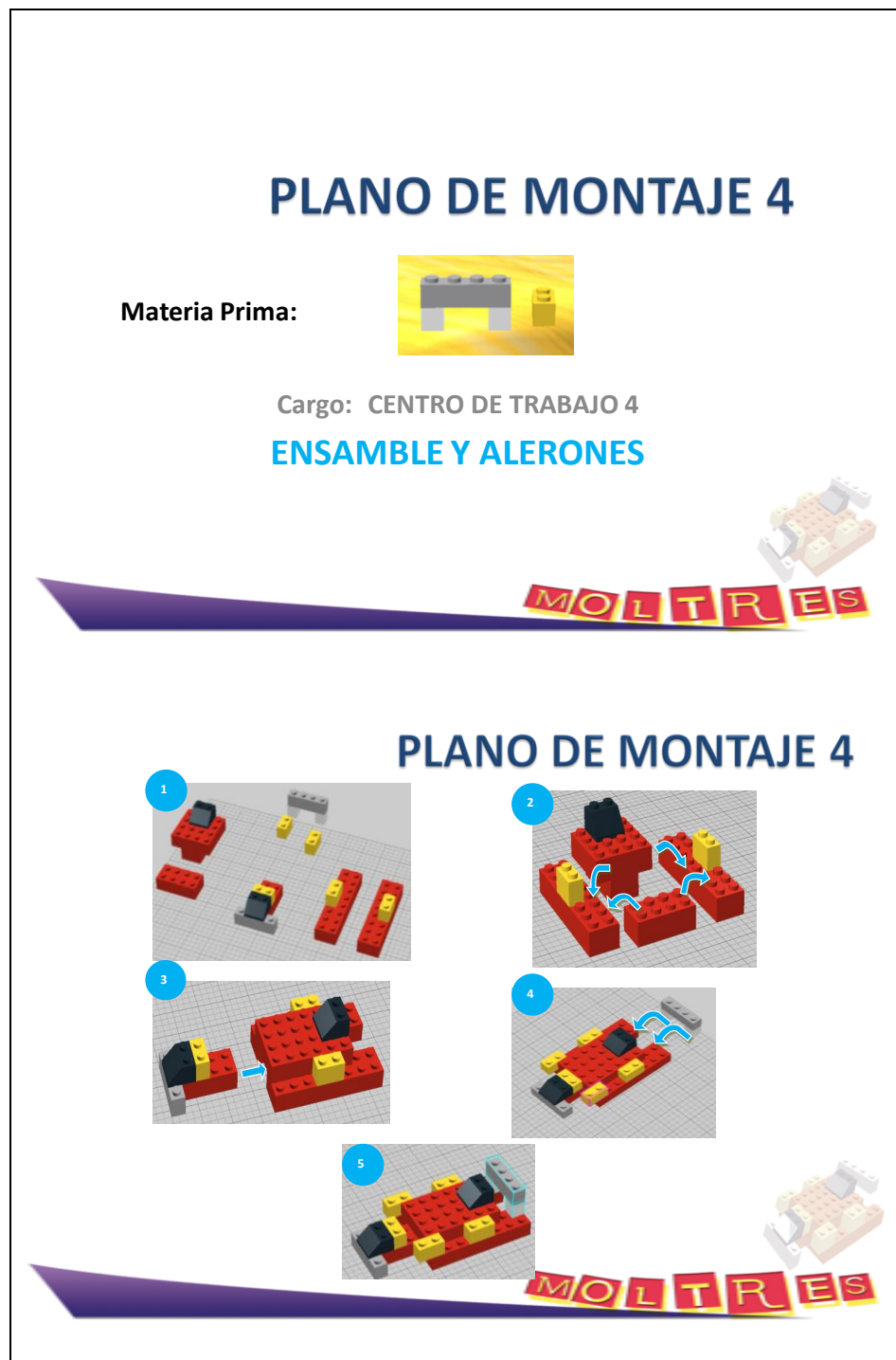
FIGURA 3.20. PLANO DE MONTAJE – CENTRO DE TRABAJO 4.
