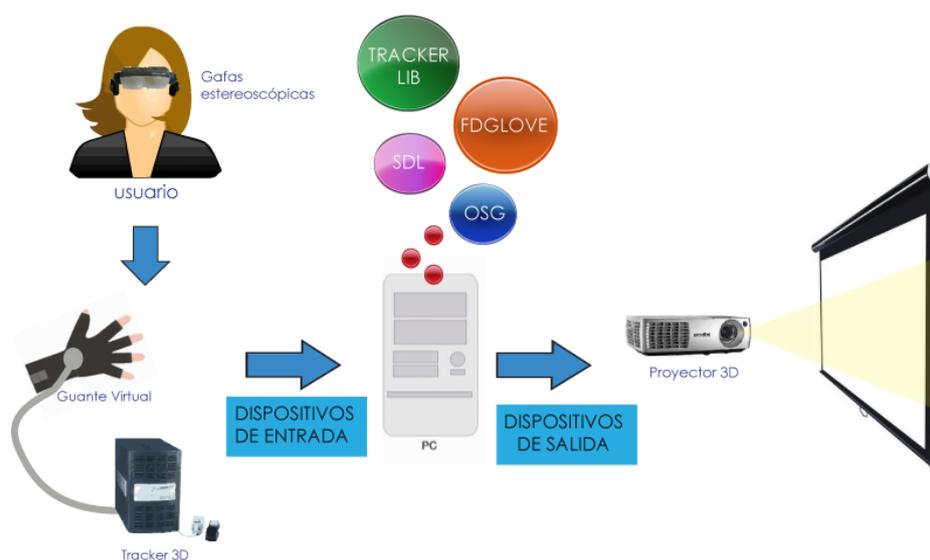
**Figura 1.1 Representación de los herramientas a utilizar.**
