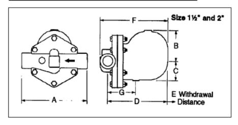
Instalación: Esta trampa debe ser instalada con el mecanismo de palanca en plano horizontal y con la dirección de flujo indicada en el mecanismo. Debe instalarse un filtro tipo "Y" a la entrada de la trampa, y un visor en la descarga para observar su funcionamiento.
