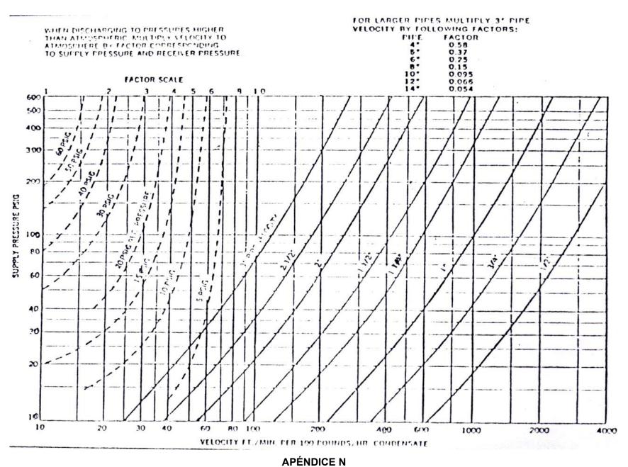
FIGURA 8.5. DIAGRAMA CAUDAL VS. CAÍDA DE PRESIÓN (PERDIDAS DE CARGA.)
