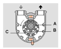
FIGURA 6.2: BOMBA DE ENGRANAJES.
