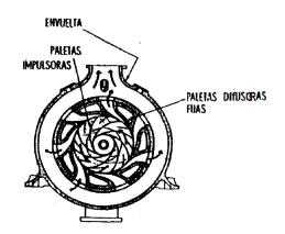
**FIGURA 5.2: BOMBA TIPO TURBINA**
