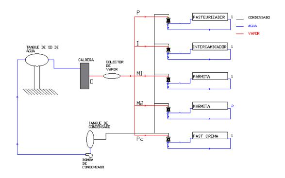
FIGURA 8.1. DISTRIBUCIÓN DE TUBERÍAS PARA EL SISTEMA DE VAPOR
