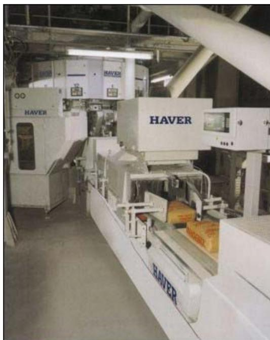
**FIGURA 1.8 ENSACADORA DE TIPO ROTATIVO**
