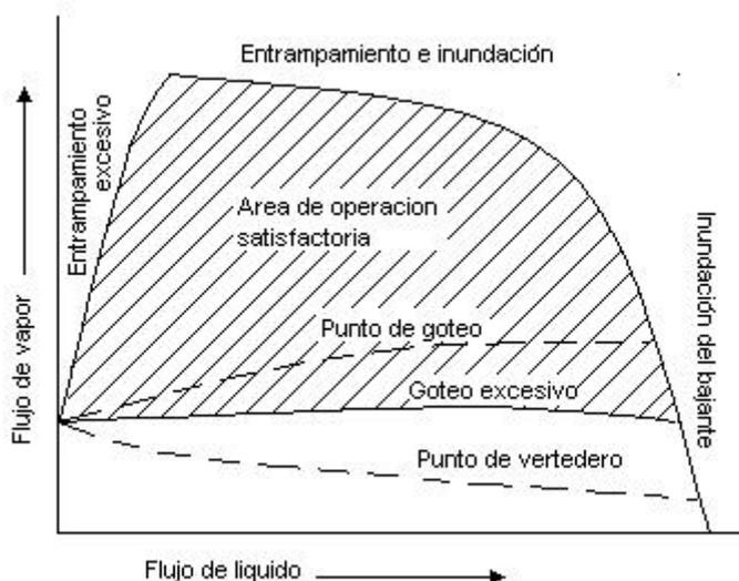
**FIGURA 4.2 DIAGRAMA DE OPERACIÓN DE UNA BANDEJA PERFORADA**
