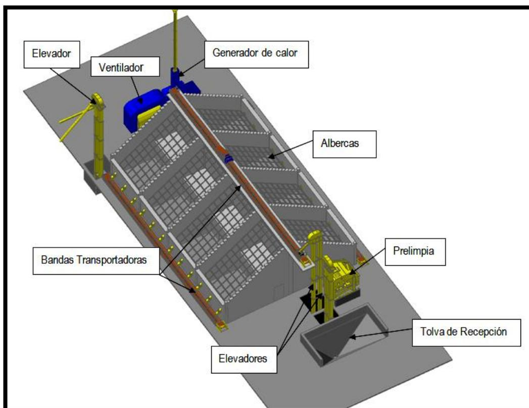
**FIGURA 2.2. COMPONENTES DE SECADORA DE TANDAS INCLINADAS**
