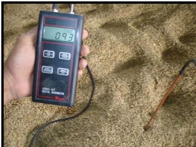
**FIGURA 1.5. TUBO DE PITOT Y MANÓMETRO EN GRANOS**
