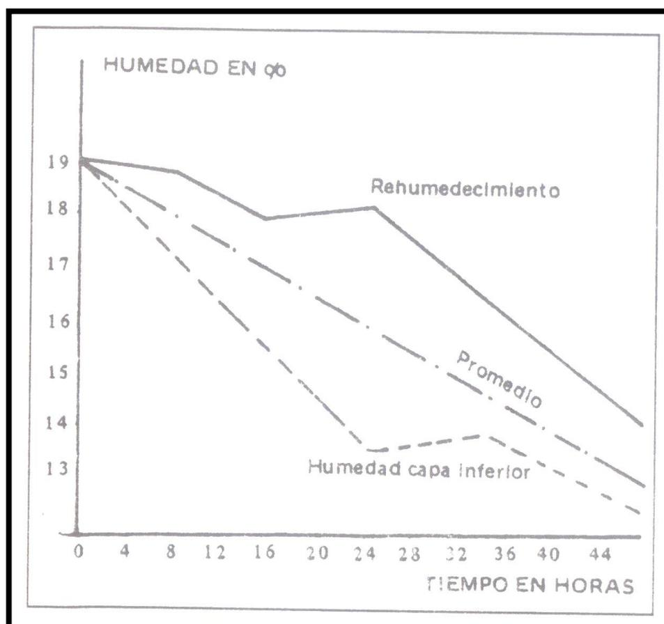
**FIGURA 1.12. VELOCIDAD DE SECADO EN ARROZ**
