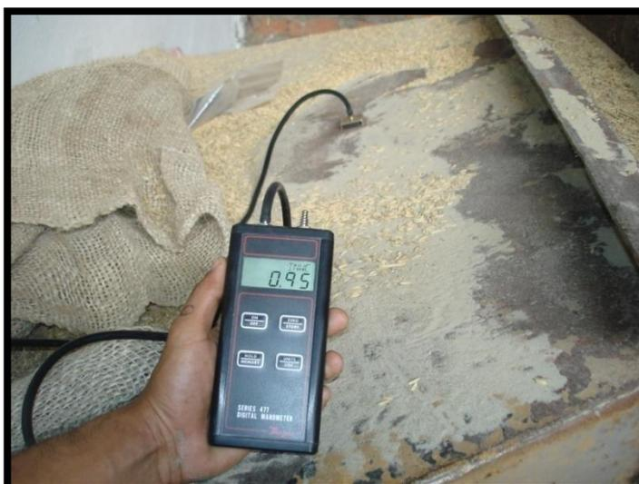
**FIGURA 1.6. TUBO DE PITOT Y MANÓMETRO EN VENTILADOR**
