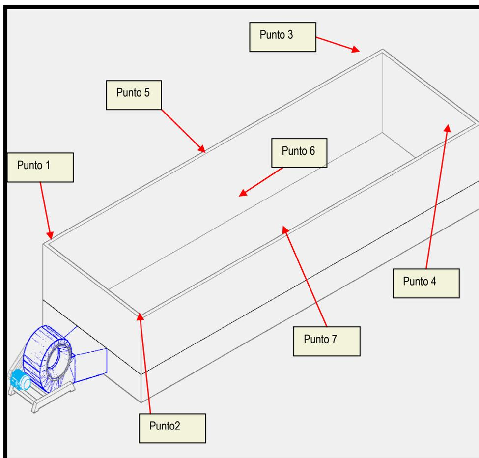
**FIGURA 1.8. PUNTOS DE MEDICIÓN PARA SECADORA DE PARADAS**
