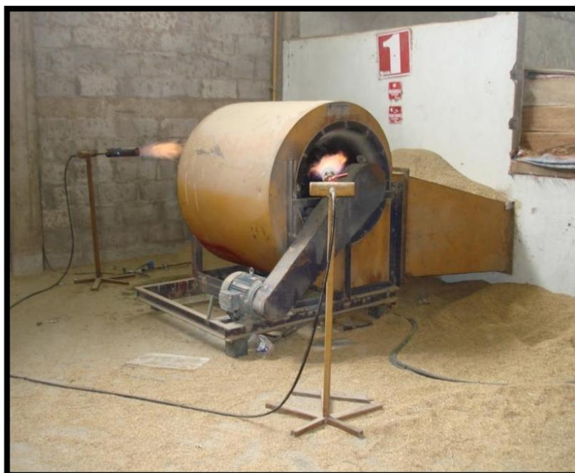
**FIGURA 1.4. VENTILADOR Y QUEMADOR DE GLP**
