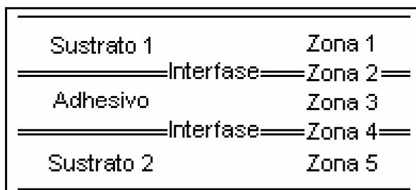
Figura 1.3. ZONAS EN UNIÓN ADHESIVA
