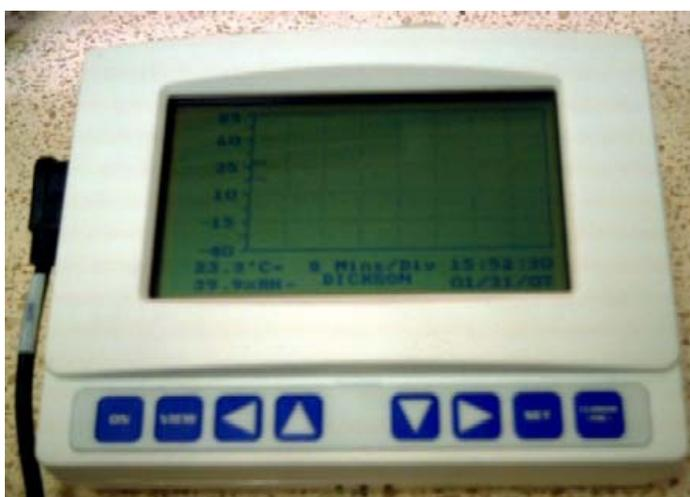
Figura 2.5 HIGRÓMETRO Y TERMÓMETRO
