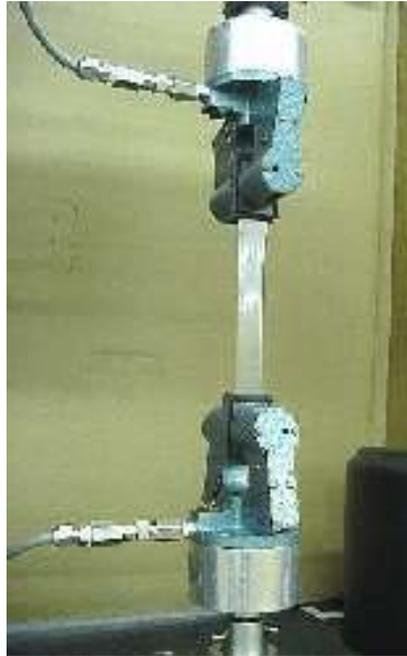
Figura 1.25: ENSAYO DE TENSION / ELONGACION
