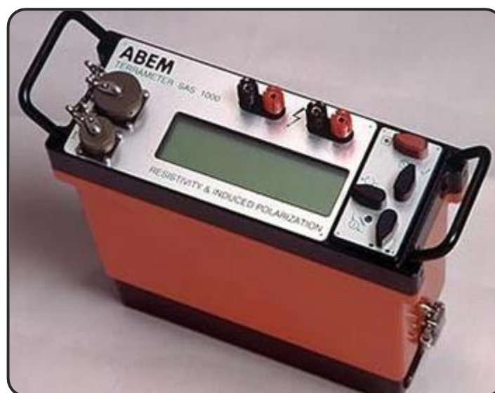
Figura 3.1. Resistivímetro TERRAMETER SAS 1000 (Fuente: www.mining-technology.com ).
