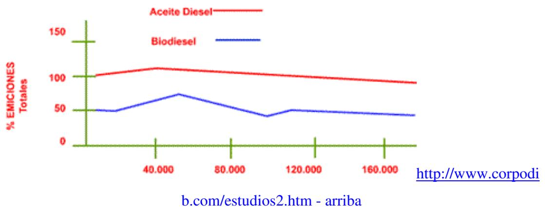
Comparación entre el biodiesel y el aceite diesel
