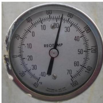
**FIGURA 3.6 DIAL DE TERMÓMETRO BIMETÁLICO EN UN TANQUE ESTACIONARIO DE GLP.**
