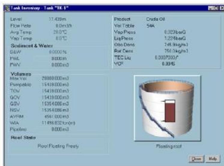
**FIGURA 4.13 PANTALLA DE INTERFAZ DEL SOFTWARE TANKMASTER**
