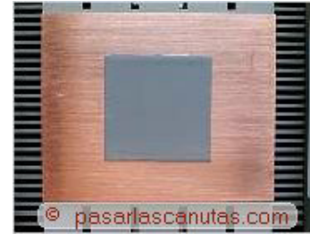
... foto del compuesto térmico (probablemente Chomerics T454 ) de cambio de estado (" phase change " - ver nuestras FAOS ) que viene puesto en el disipador de la foto anterior , en el centro del cobre.
