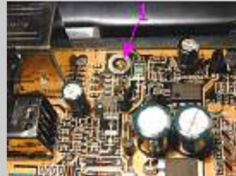
... los puntos de atornillado de la placa. En esta foto y las tres siguientes podemos ver detalle de alguno de ellos ...
