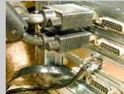
Como tengo dos pantallas, las conecto las dos, y también la placa de red y la de comunicaciones RDSI. En 2003 uso pantallas Mitsubishi Diamond Plus 74SB (NEC tiene equivalente).
