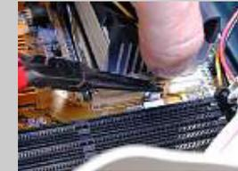
... apretando hacia abajo con el pulgar de una mano, y con la otra mano, tirando hacia afuera con la punta de los alicates, ...
