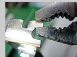
... **(muy importante)** con unos alicates, abro la pestaña, clave en el montaje de un pc para que las conexiones de las ranuras PCI no den problemas...
