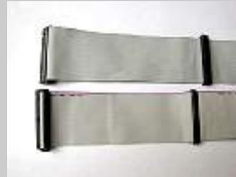
... y cojo dos cables planos para conexión de discos (el DMA66 venía en la caja de la placa base; el otro, que es un DMA33 lo he comprado para el lector de CDROM). Así lo dejo todo preparado para instalar más discos.
