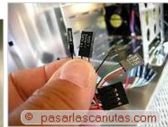
[conector\(es\) de las dos conexiones frontales USB \(que viene con dos alternativas, una de ellas con todo separado\).](#)
