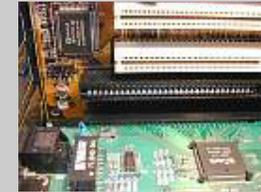
Ahora sí ha entrado el conector a tope por ambos extremos. Esto es **muy importante**, ya que una buena parte de los fallos de funcionamiento de los PC's se debe a la mala conexión y atornillado de las placas.
