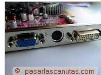
[... foto de conexiones de la tarjeta gráfica: azul la salida VGA a monitor, negra la salida de s-video/video compuesto, blanca la DVI ...](#)
