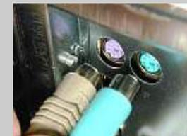
... detalle de la conexión de teclado y ratón.
