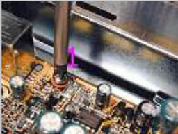
... vamos atornillando la placa base sobre los **separadores** instalados anteriormente: 1 ...
