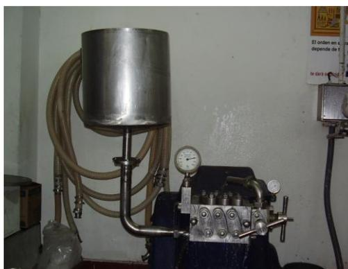
Figura 3.12 Equipo Homogenizador
