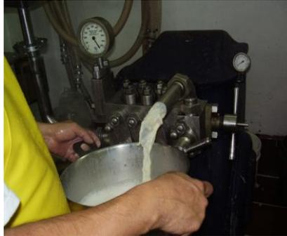
Figura 3.7 Homogenización
