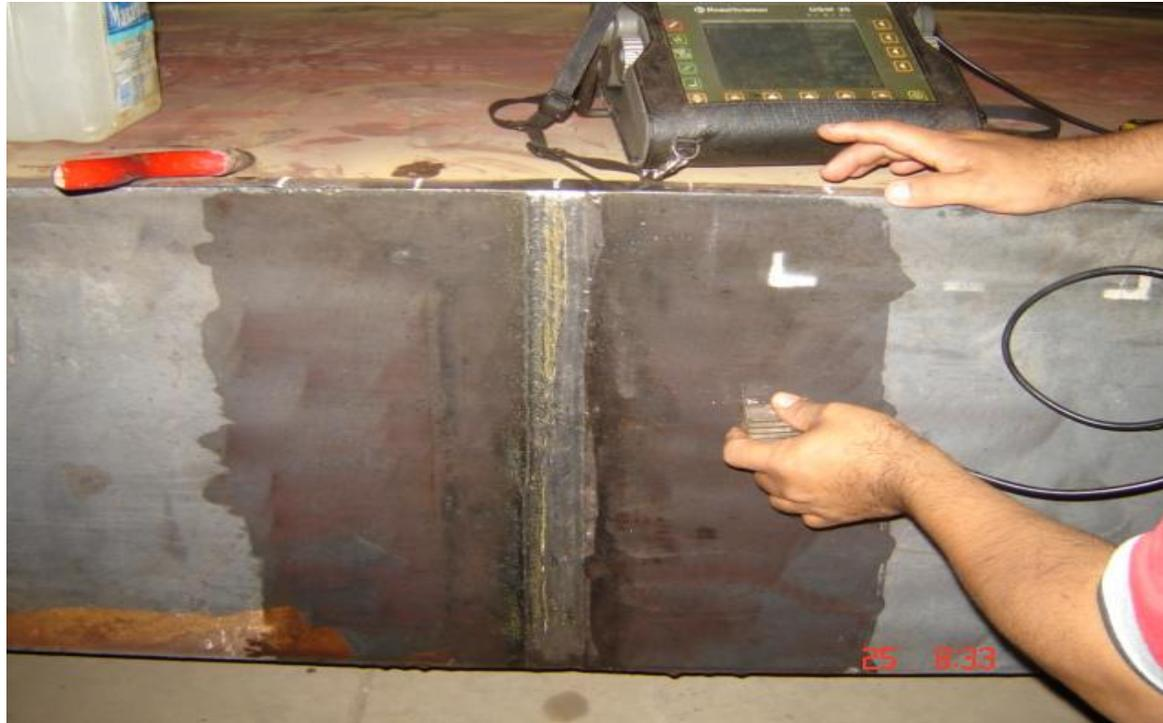
**FIG.3.6 ENSAYO POR ULTRASONIDO EN LOS TORNAPUNTAS
