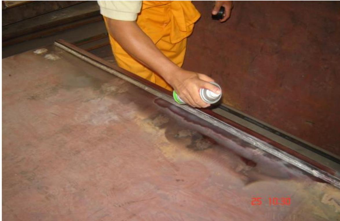
**FIG 3.7 ENSAYO POR LIQUIDOS PENETRANTES
