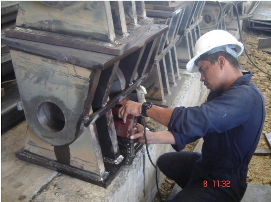
**FIG. 3.9 ENSAYO POR PARTICULAS MAGNETICAS REALIZADO EN
