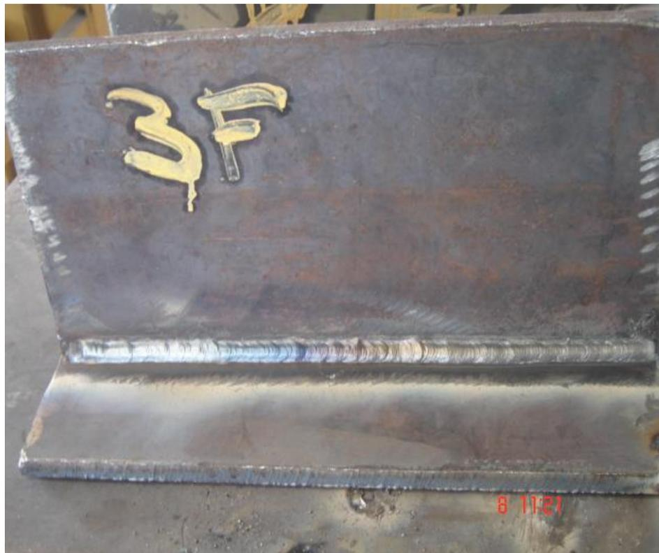
**FIGURA 2.5 PROBETA PARA WPS EN LA POSICIÓN 3F.**
