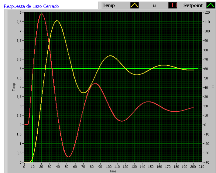
Fig. 4.13.a: Respuesta simulación horizontes: de predicción=10 - de control=4
