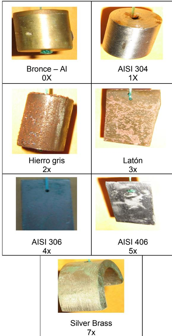
**FIGURA 2.12 MATERIALES PARA PRUEBAS DE CORROSIÓN**
