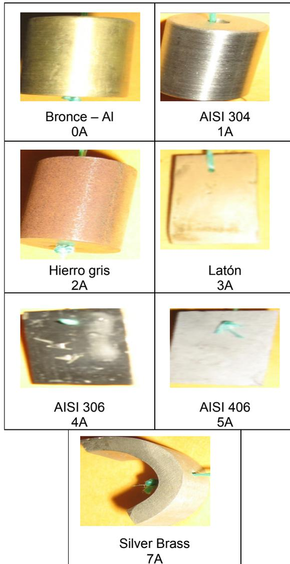
**FIGURA 2.13 MATERIALES PARA PRUEBAS DE CORROSIÓN**
