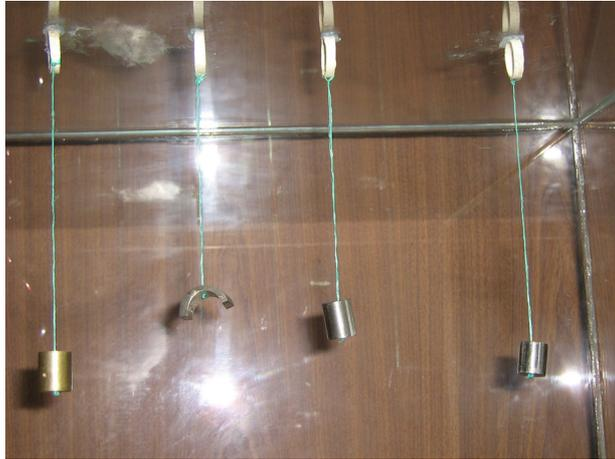
**FIGURA 2.5 MUESTRAS PARA LA PRUEBA EN SUS COLGADORES**
