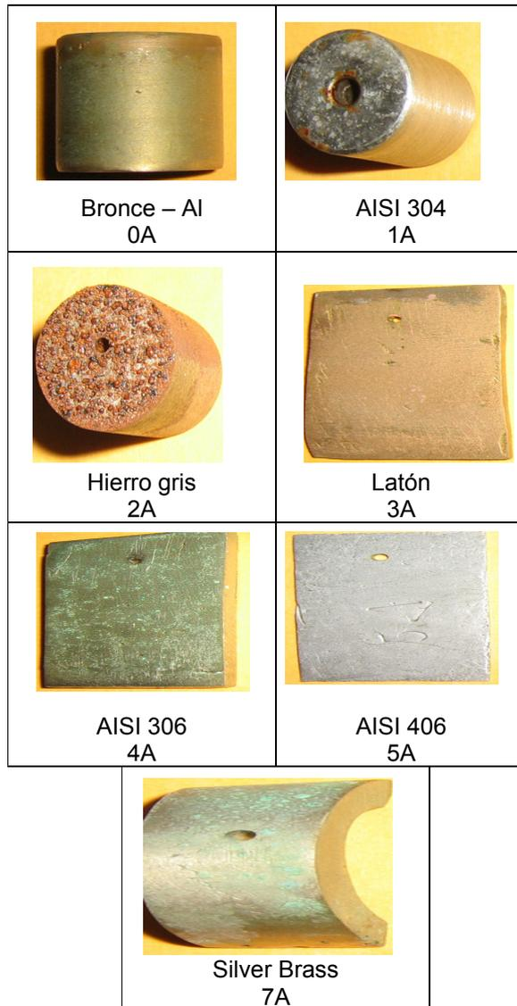
**FIGURA 2.17 MATERIALES PARA PRUEBAS DE CORROSIÓN**
