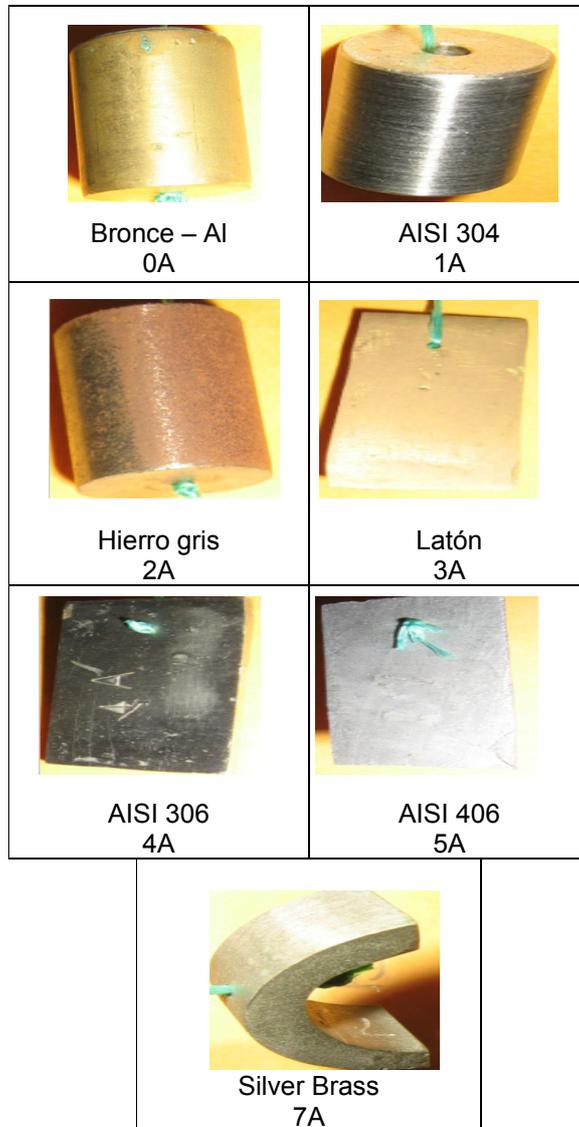
**FIGURA 2.14 MATERIALES PARA PRUEBAS DE CORROSIÓN**
