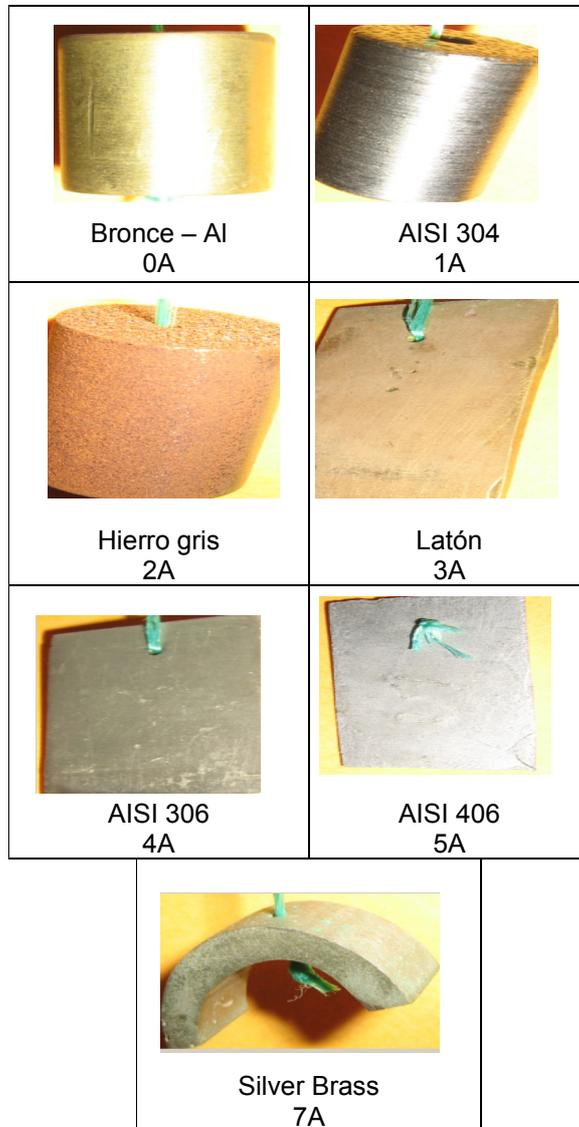
**FIGURA 2.15 MATERIALES PARA PRUEBAS DE CORROSIÓN**
