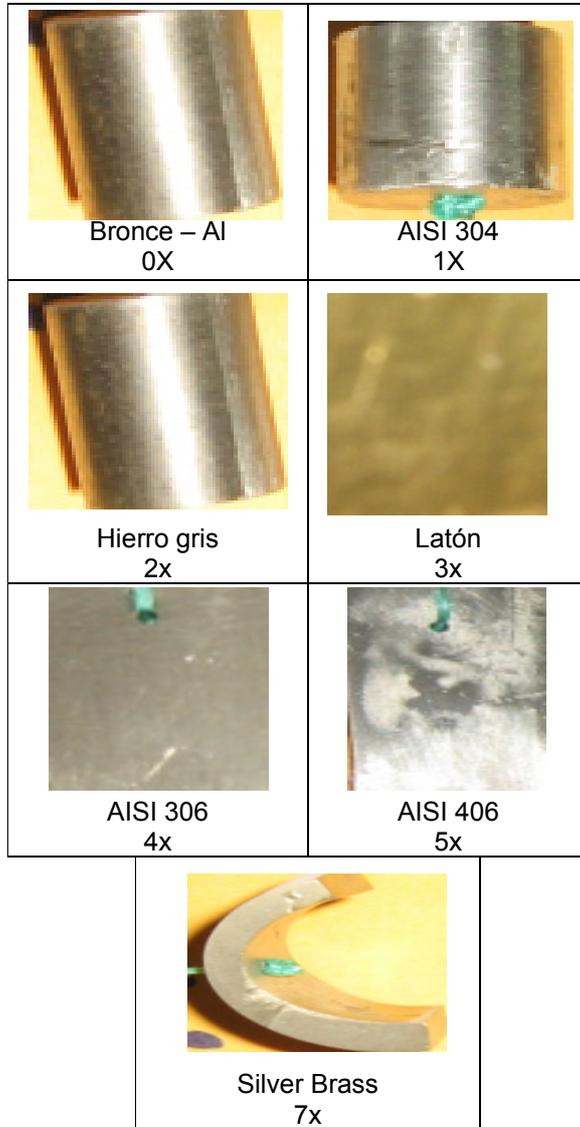
**FIGURA 2.7 MATERIALES PARA PRUEBAS DE CORROSIÓN**
