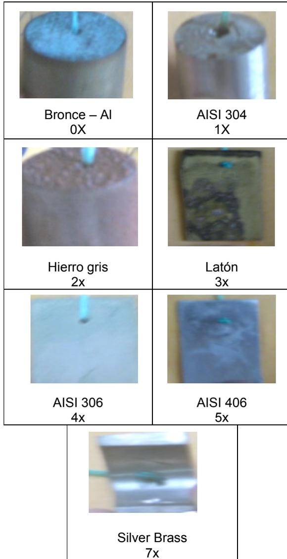
**FIGURA 2.10 MATERIALES PARA PRUEBAS DE CORROSIÓN**
