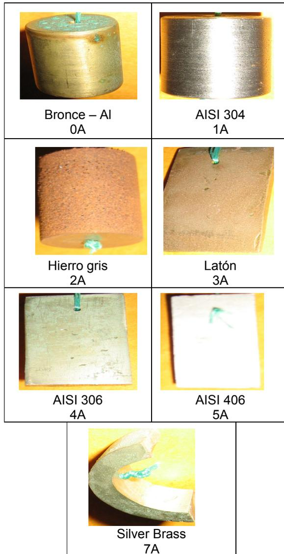
**FIGURA 2.16 MATERIALES PARA PRUEBAS DE CORROSIÓN**
