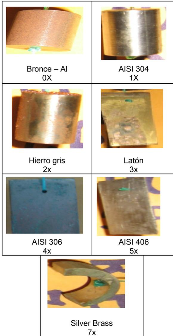
**FIGURA 2.11 MATERIALES PARA PRUEBAS DE CORROSIÓN**
