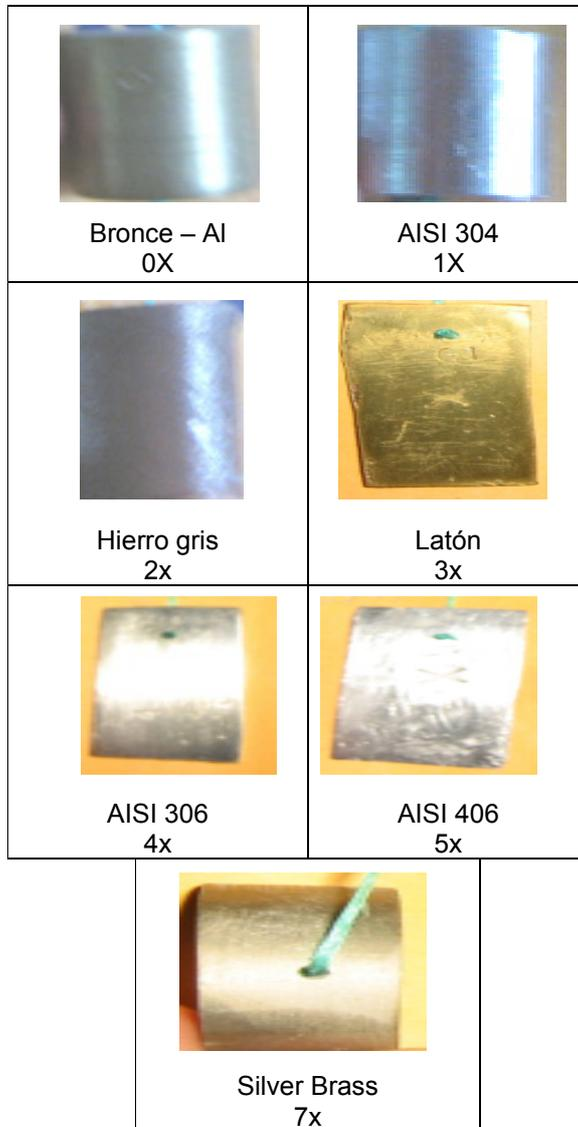
**FIGURA 2.8 MATERIALES PARA PRUEBAS DE CORROSIÓN**
