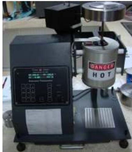
**FIGURA 4.1: MEDIDOR DE ÍNDICE DE FLUIDEZ**
