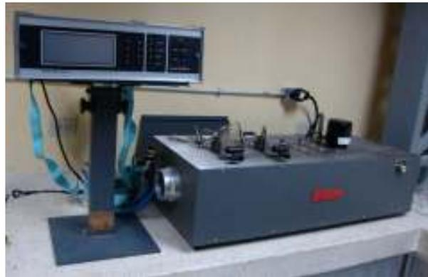
**FIGURA 4.6 EQUIPO DE TEMPERATURA DE ABLANDAMIENTO (VICAT)**
