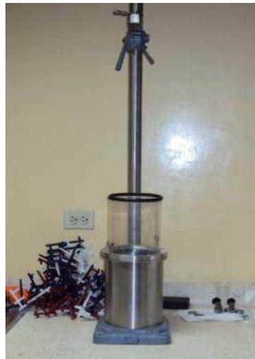
**FIGURA 4.7 EQUIPO DE ENSAYO AL DARDO.**
