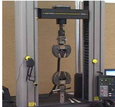
**FIGURA 4.8 MÁQUINA UNIVERSAL DE ENSAYOS DE TRACCIÓN**
