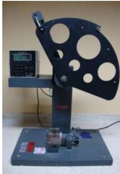
**FIGURA 4.4 EQUIPO DE ENSAYO DE IMPACTO
