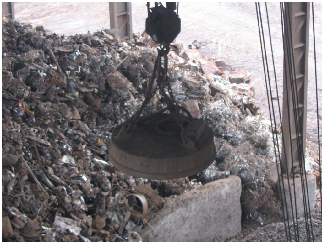
ELECTROIMAN PARA EL TRANSPORTE DE CHATARRA
