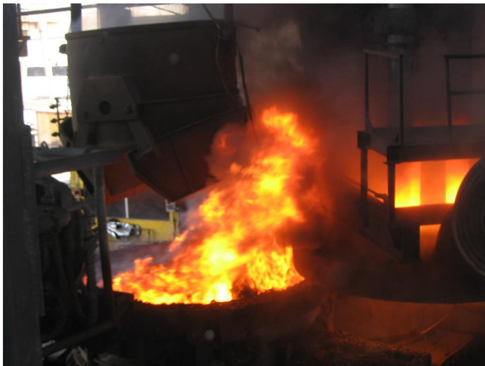
CARGA DEL HORNO CON CHATARRA
