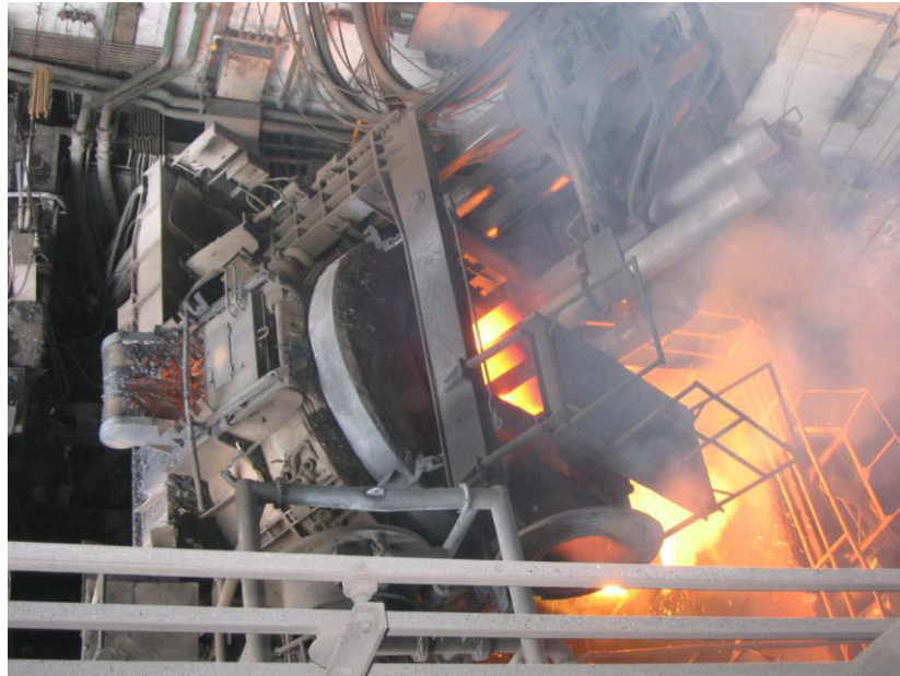
COLADO DEL ACERO FUNDIDO
