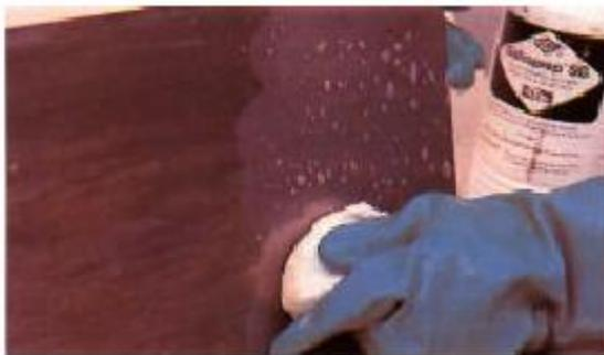
**Figura 2.1 Limpieza del área a inspeccionar**
