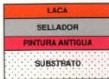
Figura 1.3 Esquema de repintado con capa de sellador
