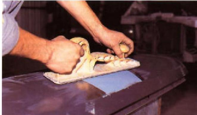
***Figura 2.2 Preparación de superficie no pintada***
