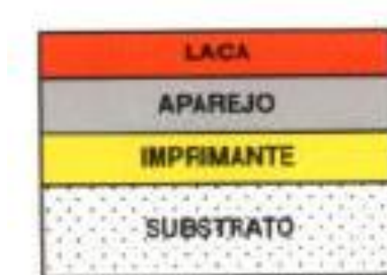
Figura 1.2 Esquema tradicional de pintado automotriz
