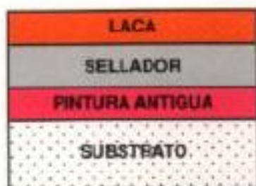
Figura 1.3 Esquema de repintado con capa de sellador
