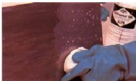
Figura 2.1 Limpieza del área a inspeccionar
