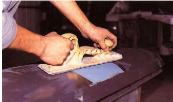
Figura 2.2 Preparación de superficie no pintada
