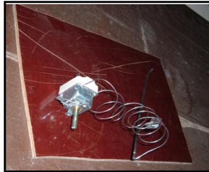
**Foto 11.** Termostato para horno
