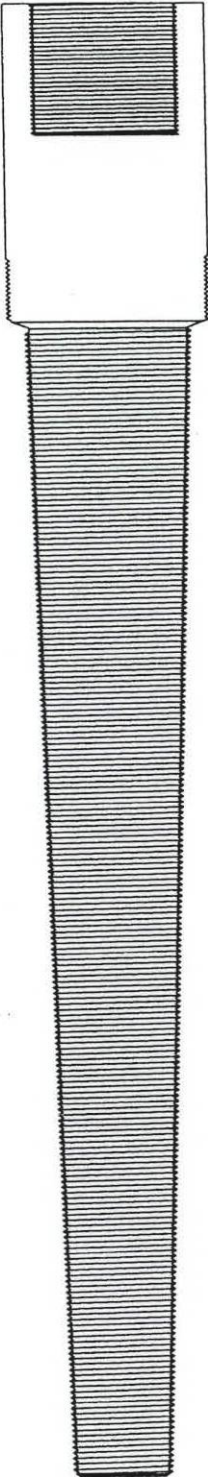
Figura 4.7 Diseño de forma del Pescante Rabo de Rata.
