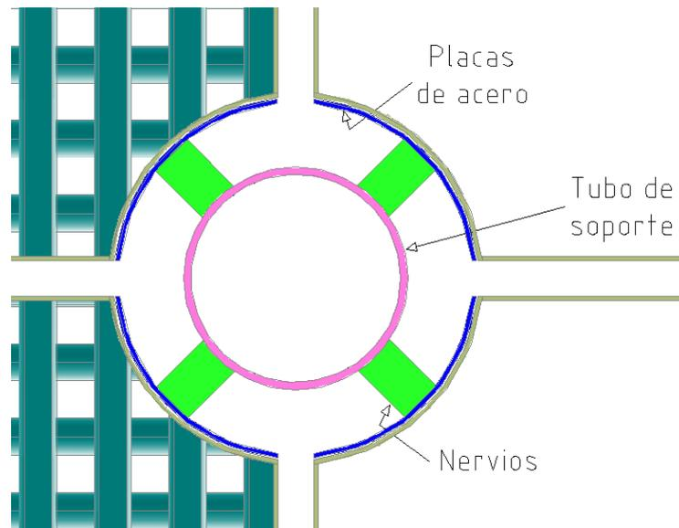
Figura 4.7. Detalle de placas de acero y nervios colocados radialmente
