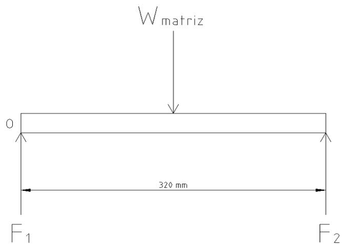
Figura 3.3. Diagrama de fuerzas sobre el eje.
