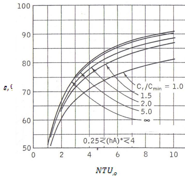
Figura 2.3. Efectividad de transferencia de calor en función del Número de Unidades de Transferencia y capacidad térmica de la matriz para  $C_{\min}/C_{\max} = 1,0$ .<sup>1</sup>
