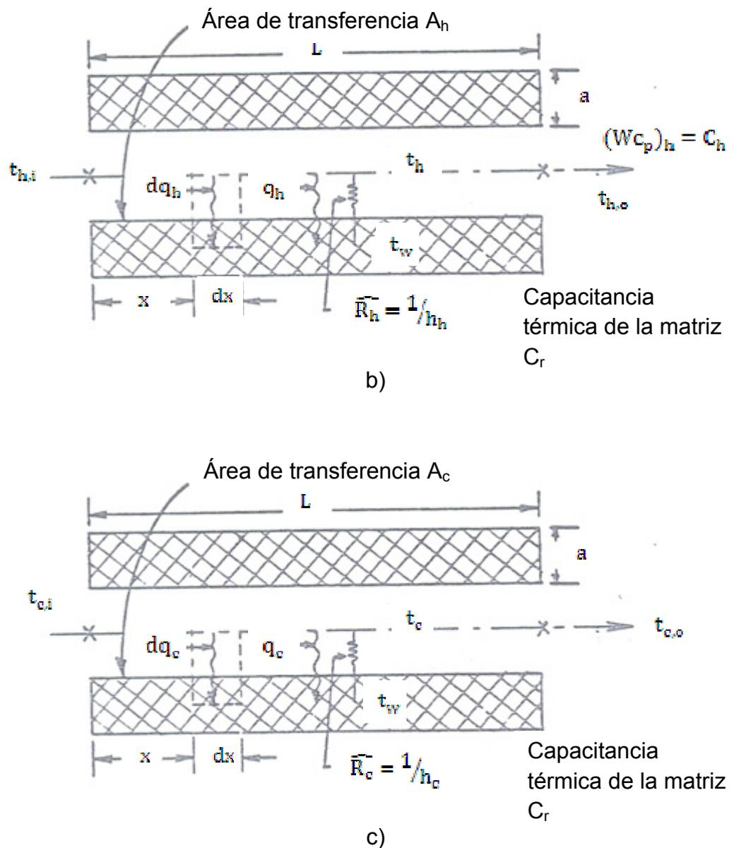
Figura 2.1. a) Regenerador rotatorio mostrando secciones  $x + dx$ , b) Canal de flujo asociado con el flujo de la matriz durante el periodo del gas caliente. c) Canal de flujo asociado con el flujo de la matriz durante el periodo del gas frío.<sup>9</sup>
