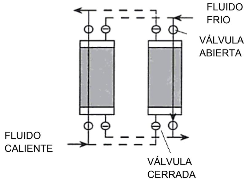
Figura 1.2. Regenerador de tipo Matrices Arregladas.<sup>1</sup>
