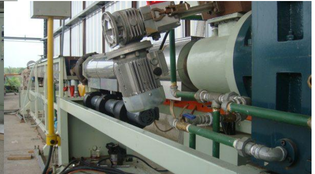
Gráfico 2.32 Extrusora GBL Machinery
