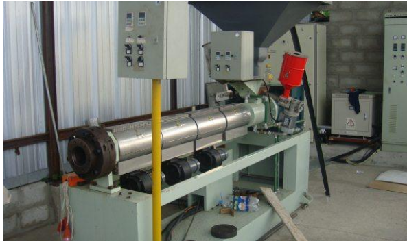
Gráfico 2.31 Extrusora GBL Machinery
