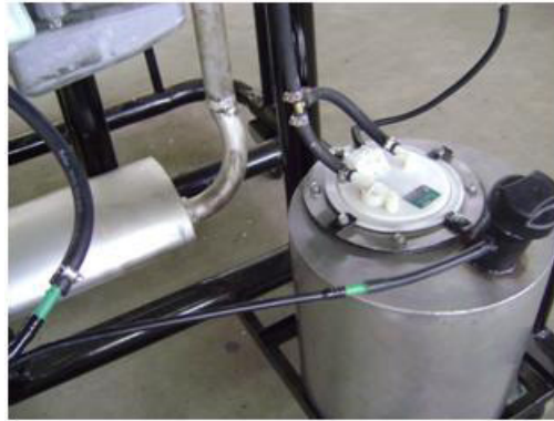
Figura 2.9 Tanque de combustible
