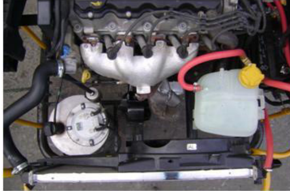
Figura 2.7 montaje del depósito de expansión
