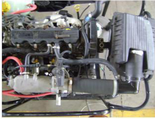
Figura 2.8 Mangueras del tapa válvulas y fijación del depurador
