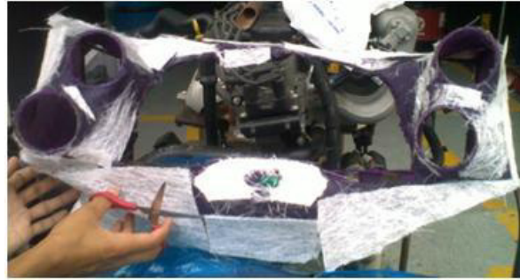
Figura 2.13 Recubrimiento con fibra de vidrio de la protección del tablero
