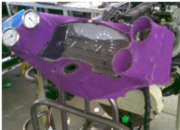
Figura 2.11 Recubrimiento con tela de la protección del tablero
