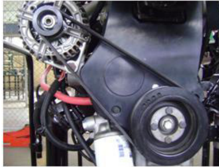
Figura 2.6 montaje del alternador
