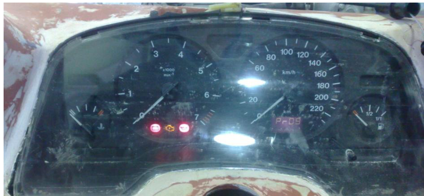
Figura 2.15 Tablero de instrumentos luego de dar contacto
