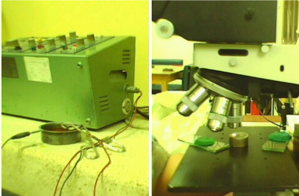
FIGURA 2.19. ATAQUE ELECTROQUÍMICO Y OBSERVACIÓN DE LA COLADA NORMALIZADA N6 7
