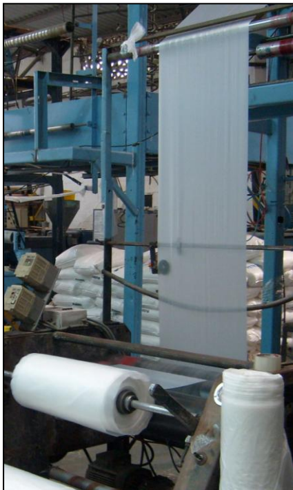
Figura 3.2 Extrusión de Rollos de Película
