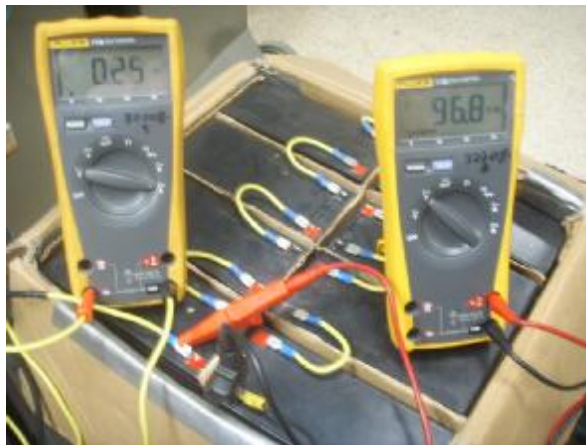
Figura 10: Corriente y Voltaje en el lado DC
