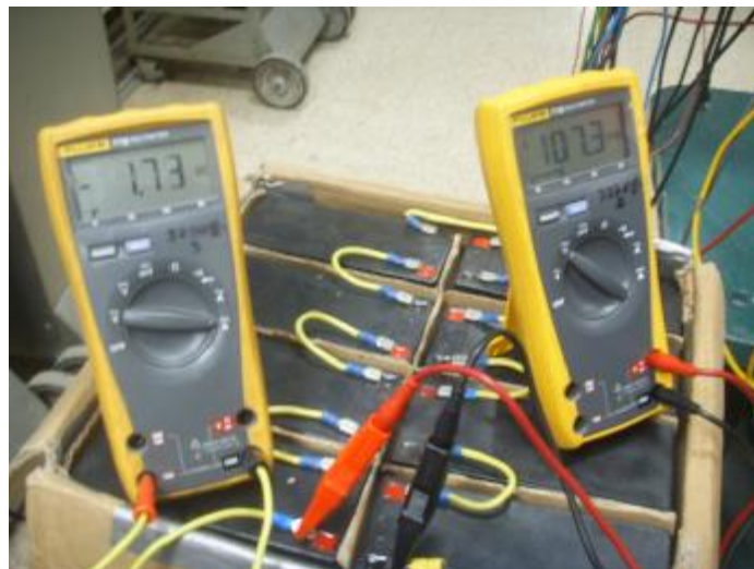
Figura 18: Corriente y Voltaje en el lado DC
