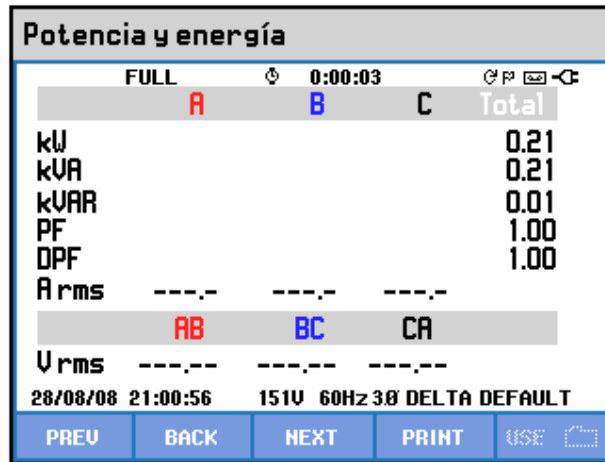
Figura 21: Potencias y Factor de Potencia Trifásica en la Carga
