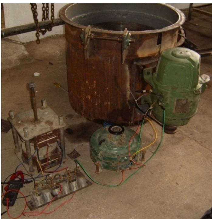
FIGURA 2.54 SISTEMA DEL MOTOR CON REÓSTATO Y RECTIFICADOR DE VOLTAJE
