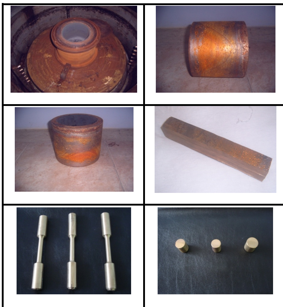
FIGURA 3.21 ETAPAS PARA LA ELABORACIÓN DE LAS PROBETAS PARA EL ENSAYO DE TRACCIÓN, DUREZA Y METALOGRAFÍA EN LAS PRUEBAS DE BRONCE.
