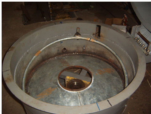
FIGURA 2.47 ETAPA DE CONSTRUCCIÓN ANILLO CIRCULAR PARA ENFRIAMIENTO
