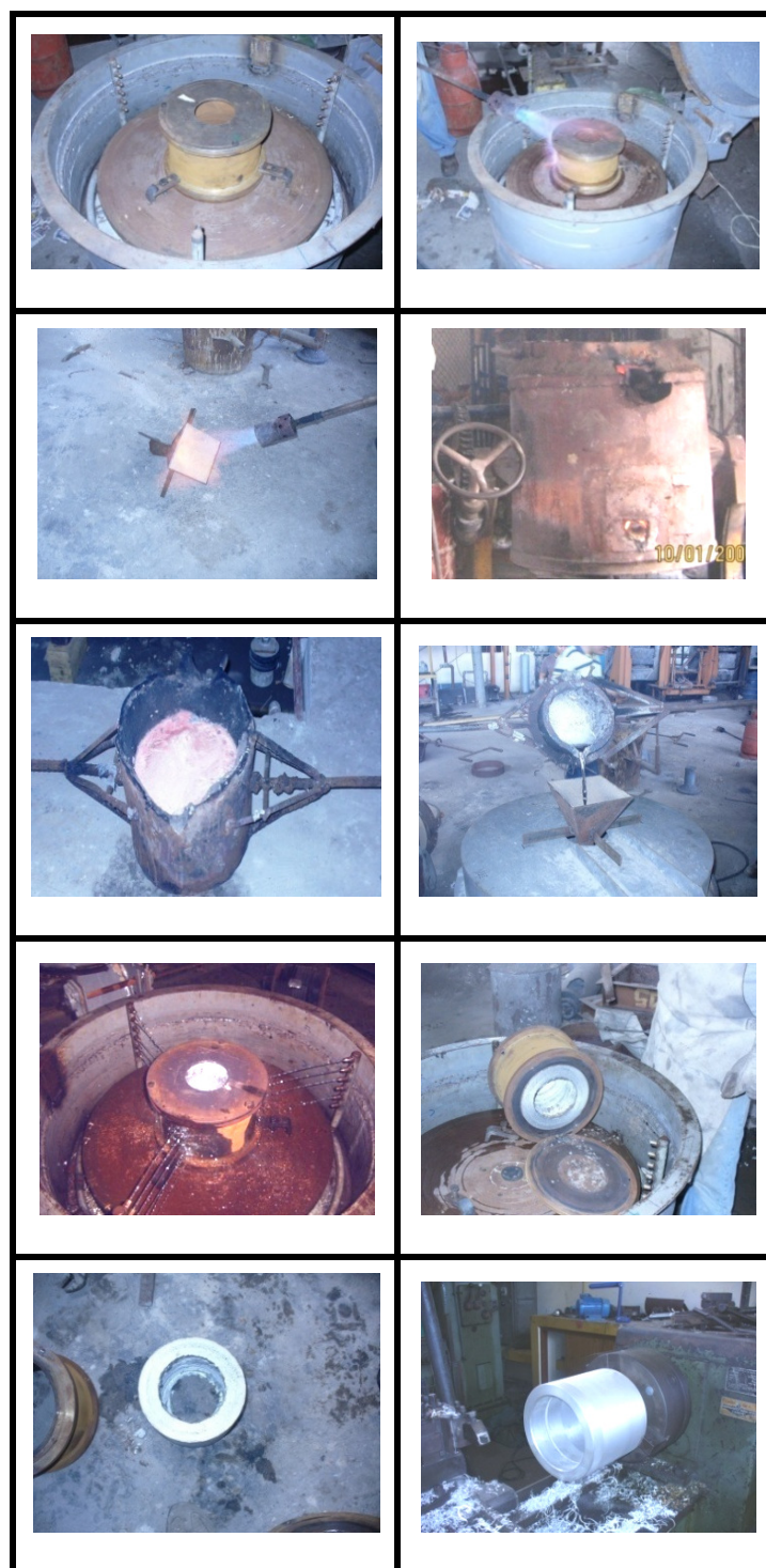
FIGURA 2.2 ETAPAS DEL PROCESO DE FUNDICIÓN CENTRÍFUGA
