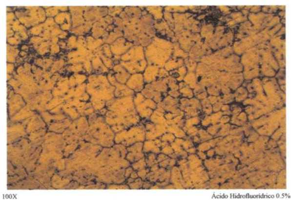
FIGURA 3.19 MICROESTRUCTURA FUNDICIÓN CENTRÍFUGA DE ALUMINIO A 800 RPM
