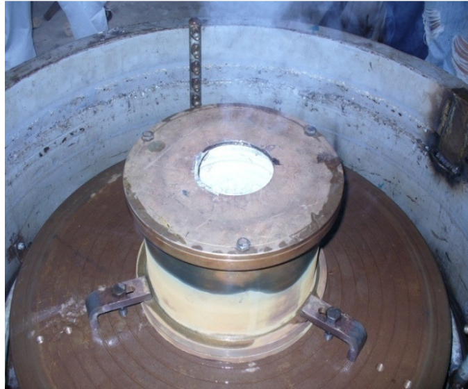
FIGURA 3.3 MOLDE INSTALADO EN LA MESA GIRATORIA.
