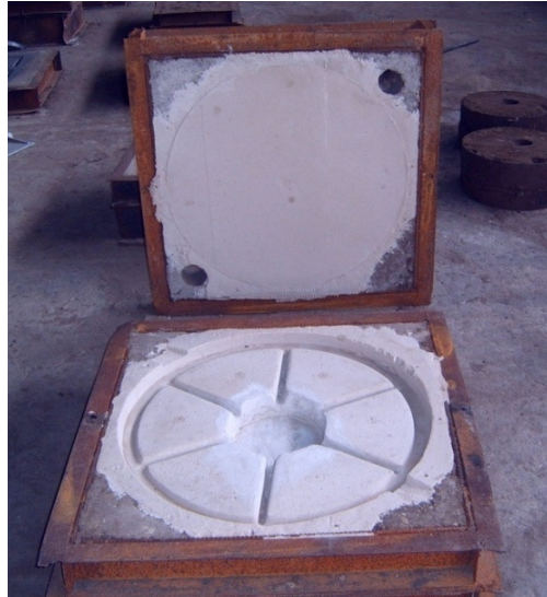
FIGURA 2.21 MOLDE PARA LA FUNDICIÓN DE LA MESA GIRATORIA
