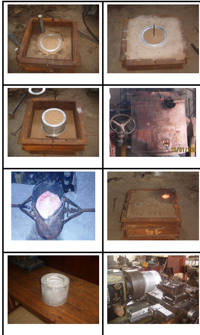
FIGURA 2.1 ETAPAS DEL PROCESO DE FUNDICIÓN EN ARENA.
