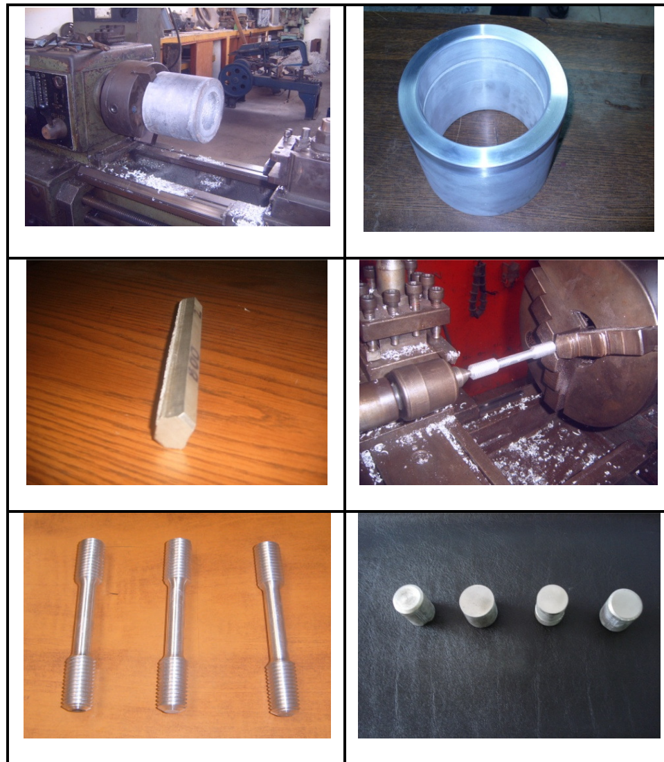
FIGURA 3.17 ETAPAS PARA LA ELABORACIÓN DE LAS PROBETAS PARA EL ENSAYO DE TRACCIÓN, DUREZA Y METALOGRAFÍA EN LAS PRUEBAS DE ALUMINIO.
