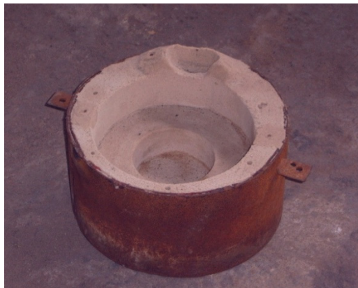
FIGURA 2.41 MOLDE DONDE SE FUNDIÓ EL ACOPLÉ.
