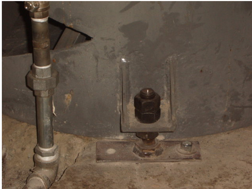
FIGURA 3.9 SISTEMA DE NIVELACIÓN DE LA MÁQUINA CON PERNOS.
