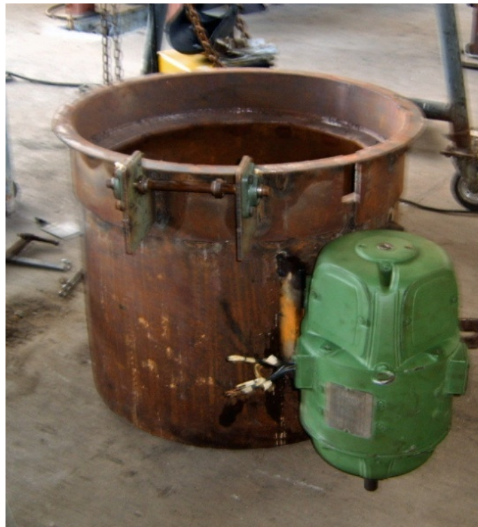
FIGURA 3.8 POSICIÓN VERTICAL DE TRABAJO PARA EL MOTOR.
