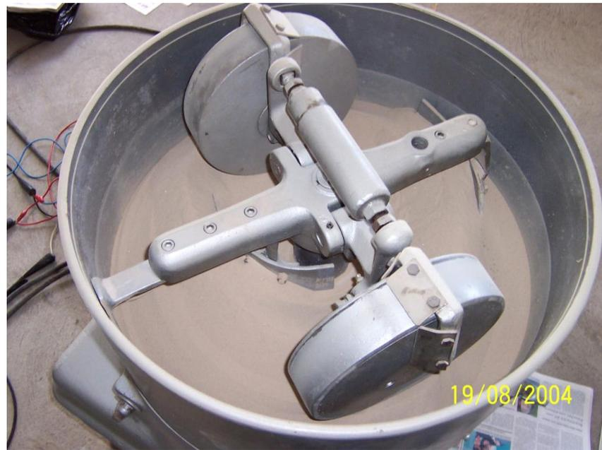
**FIGURA 2.1.** Mezclador Simpson Mix-Muller Experimental
