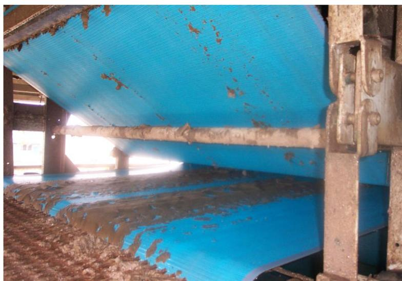
**FIGURA 1.15 VISTA DE PRENSA DE LODOS PHOENIX (LADO
