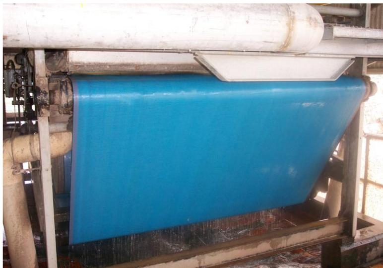
**FIGURA 1. 14 VISTA DE PRENSA DE LODOS (LADO DE ALIMENTACIÓN DE LODOS)**
