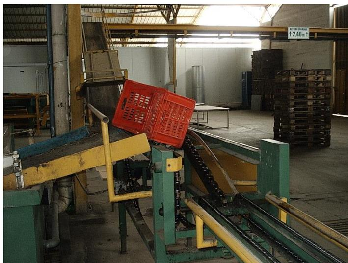
**Figura 6.3** Máquina viradora automática de gavetas
