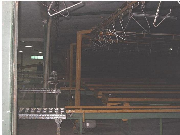
**Figura 6.4** Transportador aéreo de cajas
