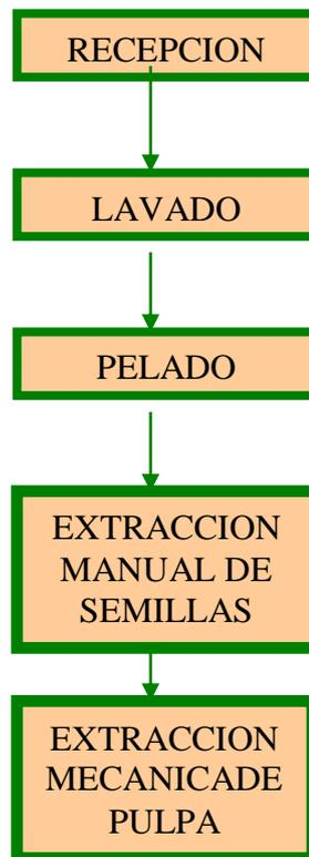
**FIGURA 3.1 DIAGRAMA DEL PROCESO DE OBTENCION DE PULPA REFINADA DE ARAZA**
