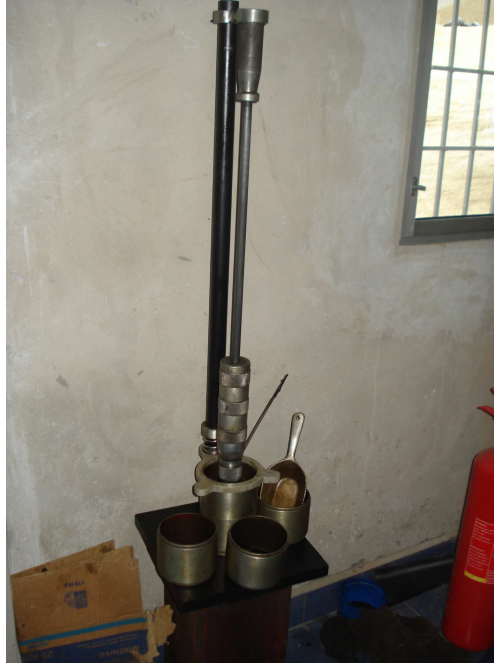
Fig. 4.1.6 – Control de la mezcla con equipo Marshall
