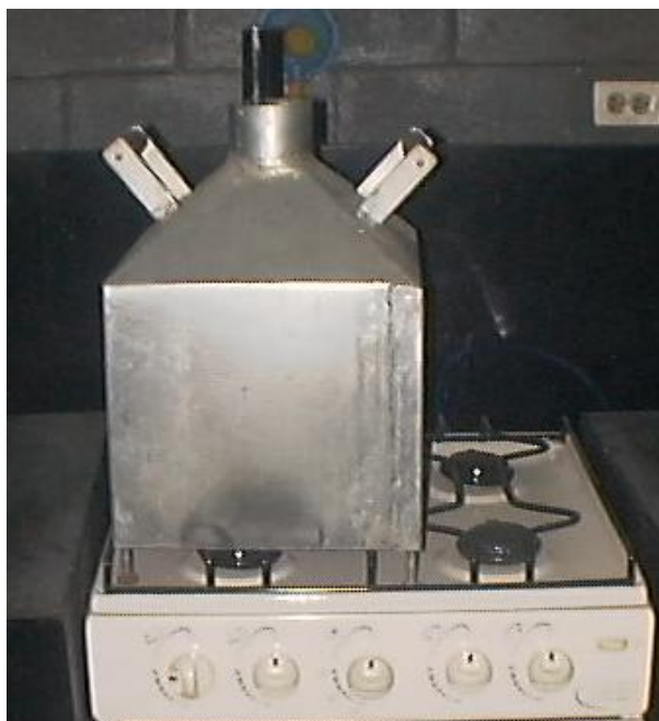
FIGURA 3.10 CAMPANA COLECTORA DE GASES.
