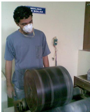
**FIGURA 3.14. Zeolita en el molino de bolas**
