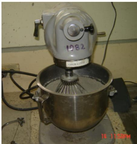
**FIGURA 3.17** Proceso de homogeneización zeolita + cemento tipo I
