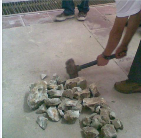
**FIGURA 3.2. Desagregación de la zeolita**
