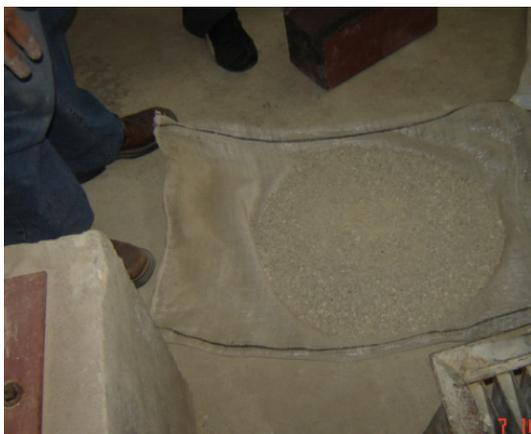
**FIGURA 3.7. Zeolita trabajada en molino de tornillo**
