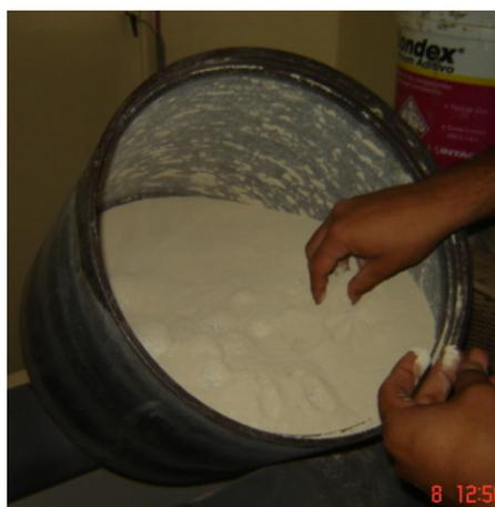
**FIGURA 3.15. Zeolita obtenida después de 45 mit.**
