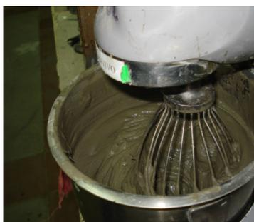
**FIGURA 3.18.** Homogeneización cemento+zeolita+agua
