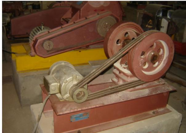
**FIGURA 3.3 Molino de mandíbulas**
