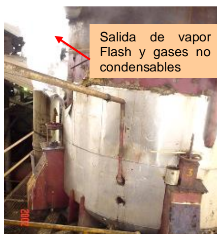
FIGURA 6.27 TANQUE DISTRIBUIDOR FLASH
