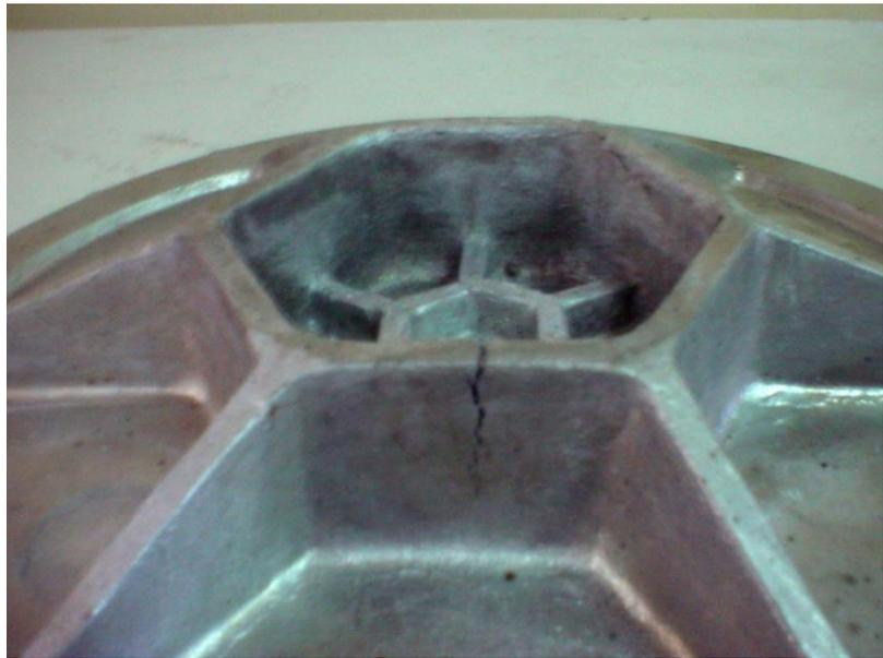
Figura 1.13. Tapa probada hasta la ruptura
