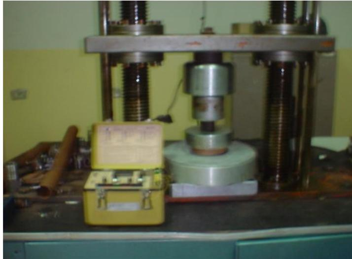
Figura 1.10. Tapa ensayada con galgas extensométricas
