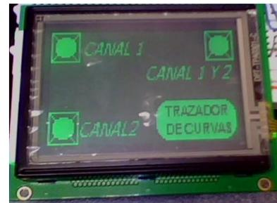
**FIGURA 6-3: FUNCIONES PRESENTADAS EN LA PANTALLA TÁCTIL**
