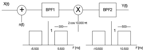
**Problema2 (25pts)** Un transmisor tiene un diagrama de bloques mostrado en la siguiente figura. La respuesta de frecuencia es plana en el rango  $20 \text{ Hz} - 15 \text{ KHz}$ . La salida del transmisor tiene una portadora de  $103.7 \text{ MHz}$  y una desviación pico de  $75 \text{ KHz}$ .
