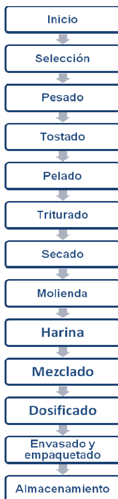
Figura 1.3.3 Esquema de Elaboración de Sopa Instantánea.
