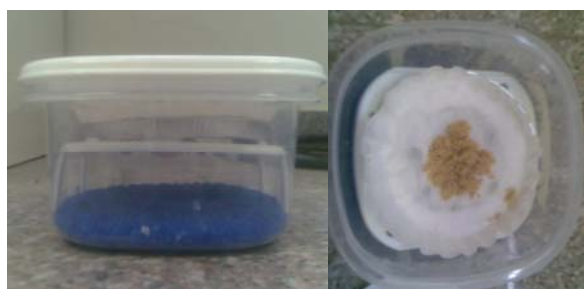
Figura 2.3.a Vianda plástica con 100g de sílica gel, y 10g de muestra.
