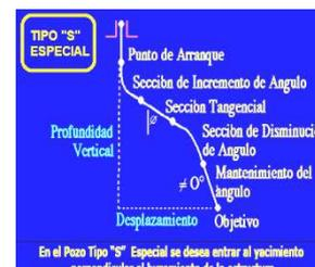
Figura 4. Pozo Direccional Tipo “S” Especial.
