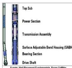
Figura 9. Elementos de un Motor Steerable.
