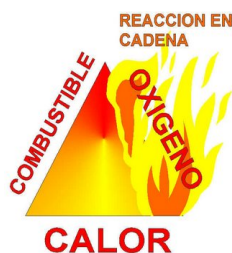
Figura 4. Triángulo de fuego
