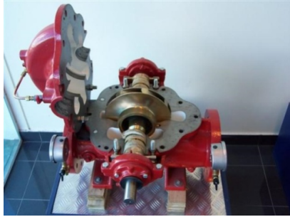
Figura 5. Bomba contra incendio de carcasa dividida horizontalmente
