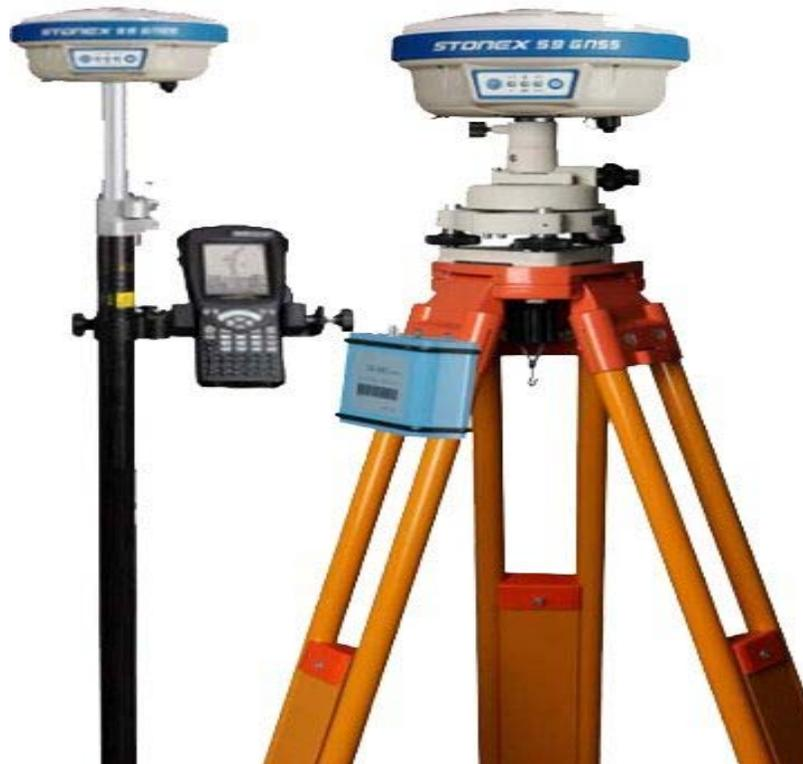
**FIGURA 4.11 : Georeferenciador satelital (GNSS).**
