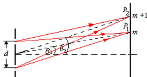
y franjas amarillas (los máximos) entre ellas. El punto  $P_1$  corresponde a la posición de un máximo de orden  $m$  y el punto  $P_2$  corresponde al máximo adyacente de orden  $(m + 1)$ . La posición angular del máximo de orden  $m$  es  $\theta_1$  y del máximo  $(m + 1)$  es  $\theta_2$ . Utilizando la fórmula de los máximos de interferencia, se obtiene para el orden  $m$
