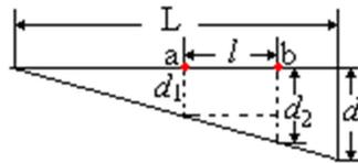
Para estos dos puntos se cumple la condición de los mínimos de interferencia por reflexión en las láminas delgadas
