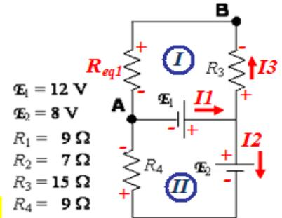
**La corriente que circula por el resistor  $R_4$  es:  $I_2=0.44\text{A}$ .**
