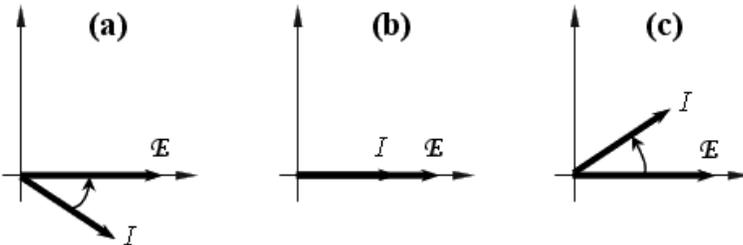
Debido a que la reactancia inductiva es mayor que la reactancia capacitiva, el circuito es más inductivo que capacitivo, entonces el voltaje del circuito adelanta a la corriente.
