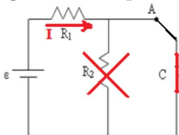
A  $t=0$ , el capacitor se comporta como un corto, por tanto no pasa corriente por el resistor  $R_2$ .
