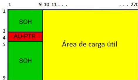
**Figura 1 Estructura de un STM-N.**
