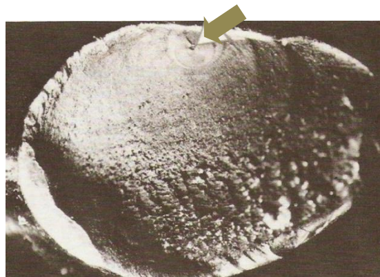
FIGURA 1.24. FALLO POR FATIGA EN UN RESORTE DE ACERO ENDURECIDO ORIGINÁNDOSE EN UNA INCLUSIÓN SUBSUPERFICIAL
