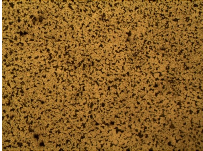
FIGURA 3.4: MICROESTRUCTURA SECCIÓN TRANSVERSAL (100 X). NITAL 3%
