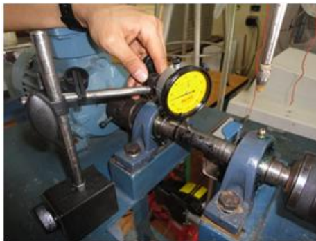
FIGURA 3.18: IMAGEN TOMADA DURANTE LA VERIFICACIÓN DE LA ALINEACIÓN DE LA MÁQUINA
