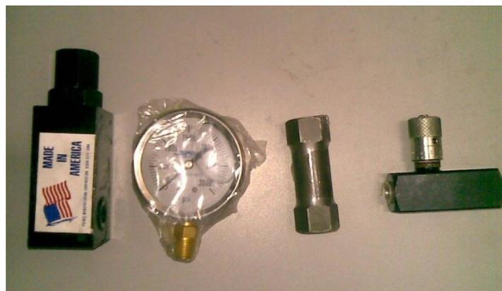
**FIGURA 1.11 ELEMENTOS HIDRÁULICOS DEL CIRCUITO**
