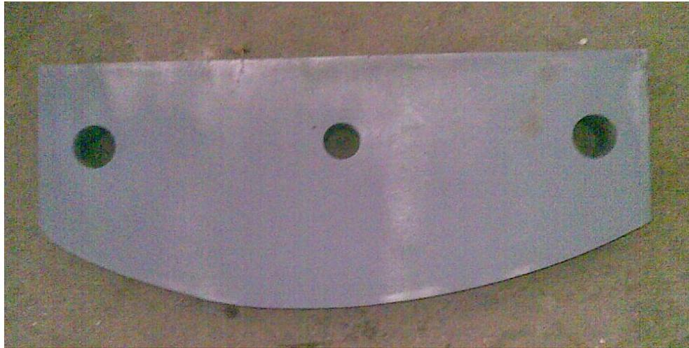
**FIGURA 2.7 FORMA REAL DE PLACA SEPARADORA DE BARRAS FIJAS.**
