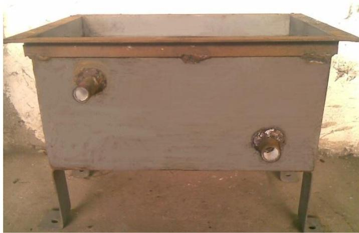
**FIGURA 2.14 RESERVORIO DE ACEITE DE MÁQUINA DE ENSAYOS**
