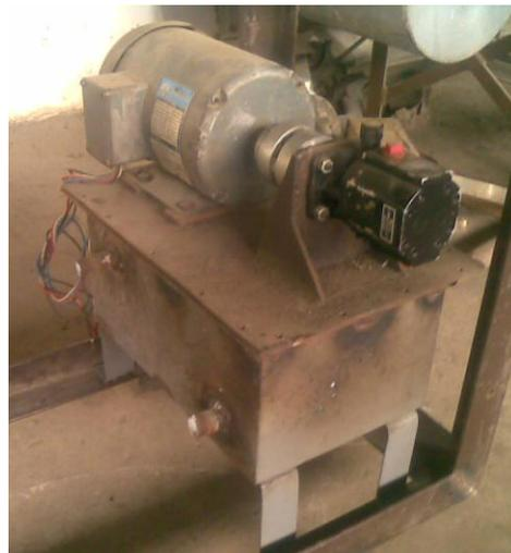
**FIGURA 2.17 SISTEMA MOTOR BOMBA HIDRÁULICA**
