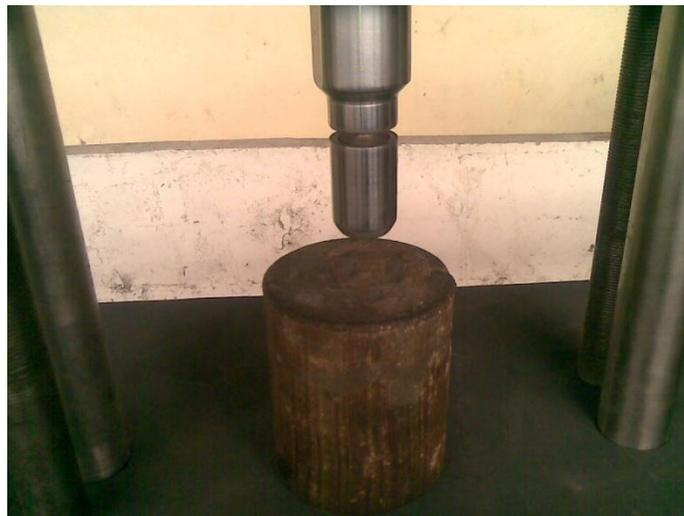
**FIGURA 2.24 PENETRADOR PARA ENSAYOS EN ESCALA**
